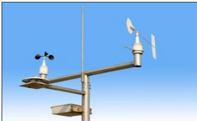
该装置由风速传感器、风向传感器、日照辐射表、测温探头、控制盒及支架组成。可测量环境温度、风速、风向和辐射强度等参量，其通讯接口可接入并网监控装置的监测系统，实时记录环境数据。
