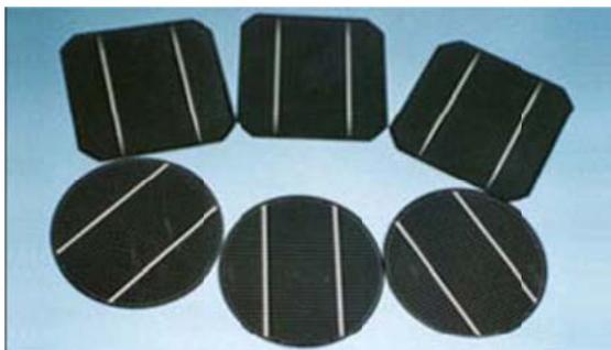
图 5.1-1 单晶硅硅片
